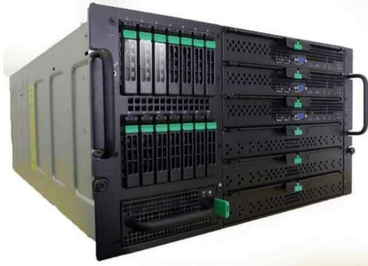
*Рисунок 6. MFSYS25: модульний сервер від Intel*
