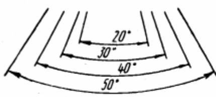
Розміщення розмірних чисел кутових розмірів на концентричних розмірних лініях.
