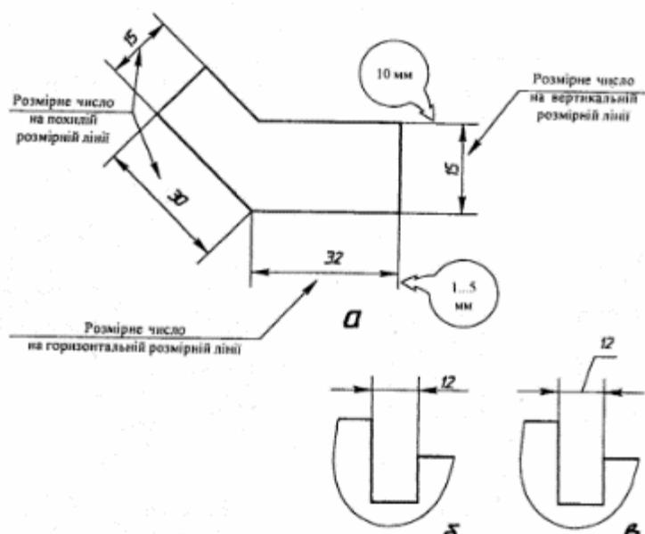
При великій кількості розмірів розмірні числа наносять в шаховому порядку для зручності читання.
