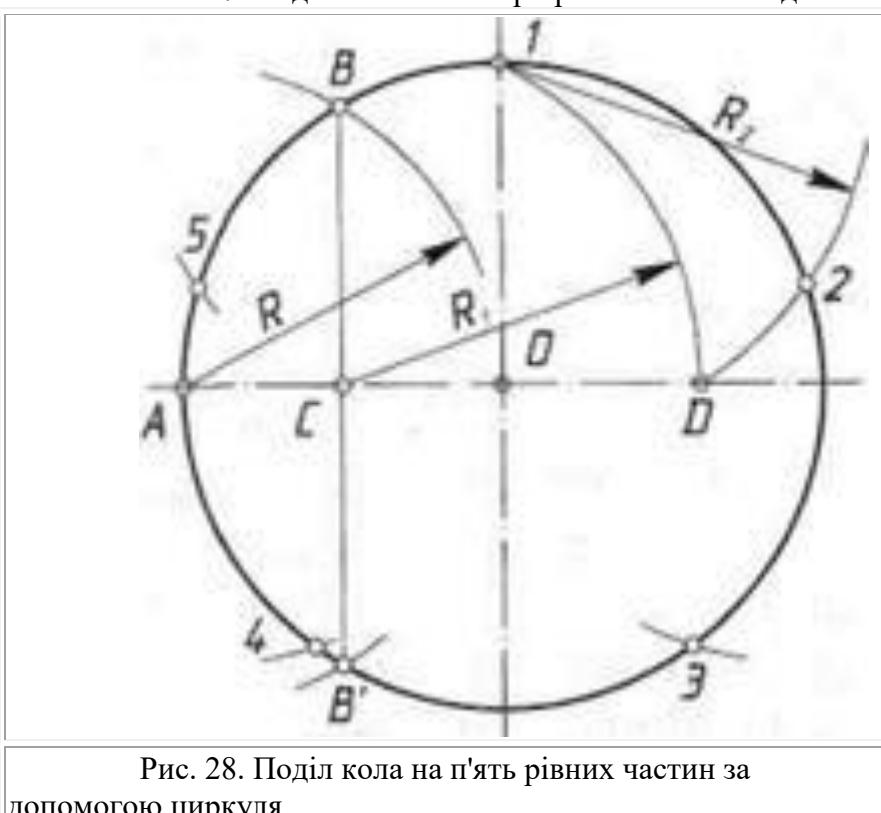
Рис. 28. Поділ кола на п'ять рівних частин за допомогою циркуля
