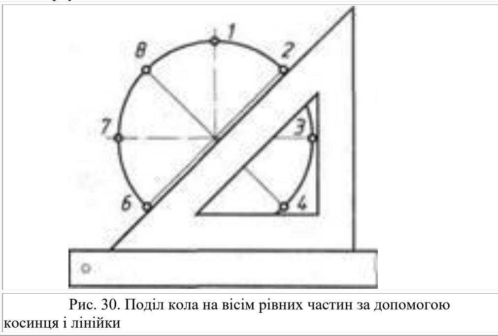
Рис. 30. Поділ кола на вісім рівних частин за допомогою косинця і лінійки
