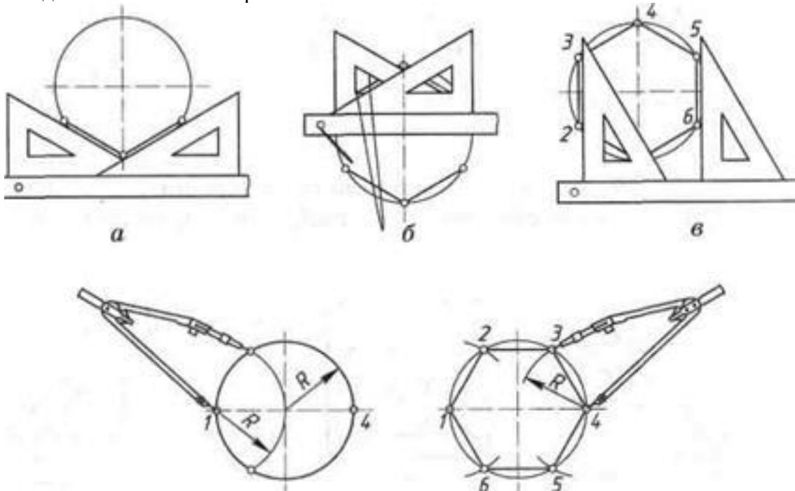
Рис. 29. Поділ кола на шість рівних частин: а, б, в — за допомогою косинця і лінійки; г, д — циркулем
