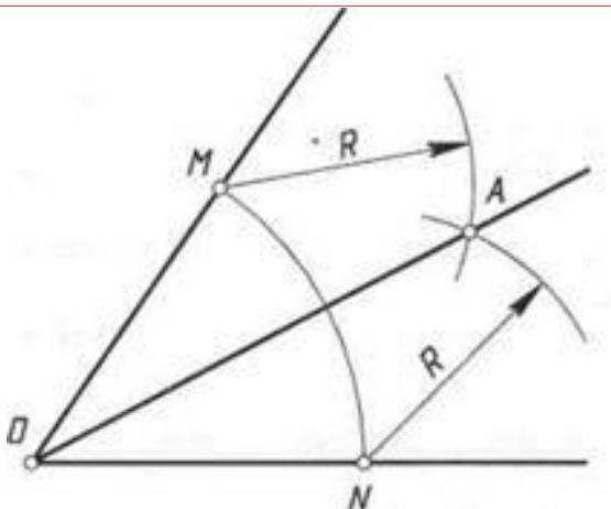
Рис.24. Поділ кута на дві рівні частини за допомогою циркуля
