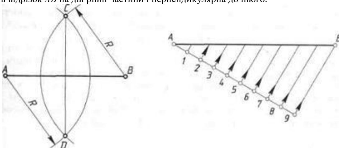
Рис. 22. Поділ відрізка прямої на дві рівні частини за допомогою циркуля
