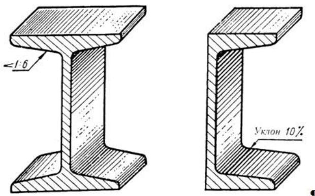
Рис. 1. Елементи технічних поверхонь з уклонами ¶
