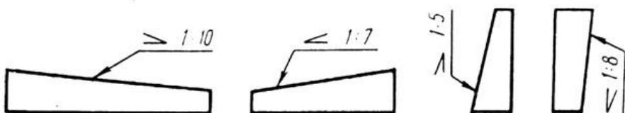
Рис. 3. Позначення уклону
