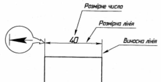
Нанесення стрілок розмірної лінії при близькому розташуванні контурних ліній.
