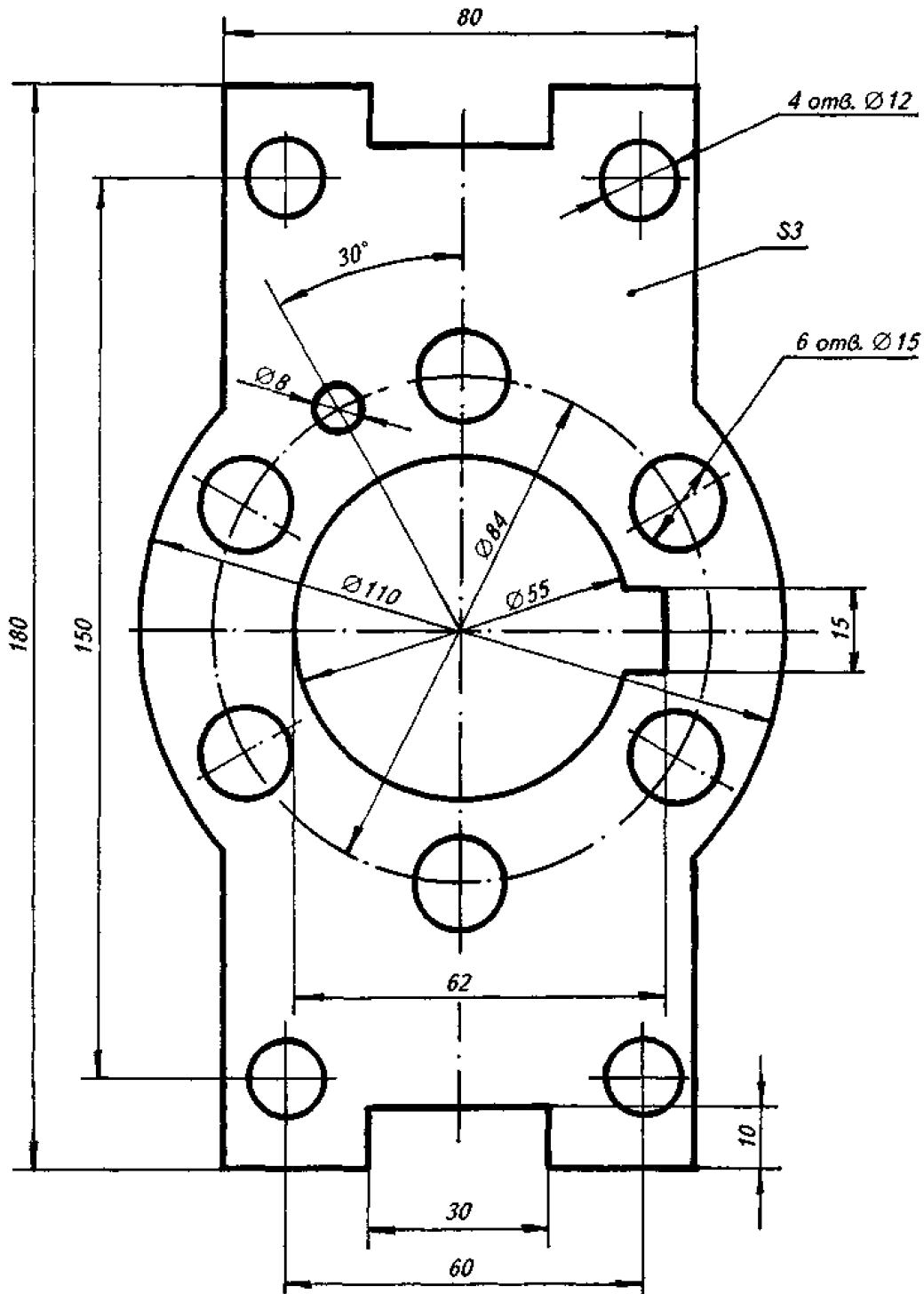
Нанесення розмірів на плоскій деталі
