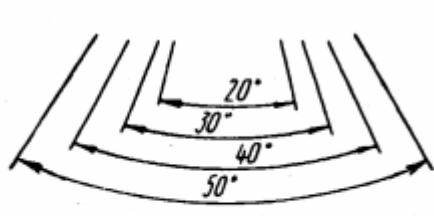
Розміщення розмірних чисел кутових розмірів на концентричних розмірних лініях.
