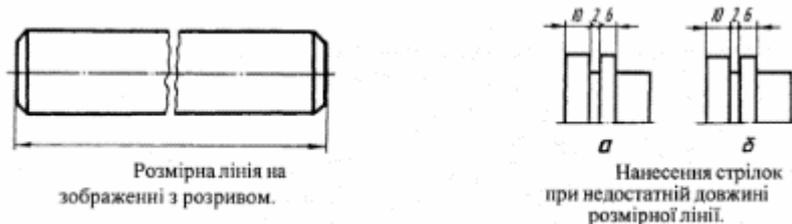
лінія у вигляді дуги. Розмірне число пишеться над розмірною лінією або на лінії виносці. Розмір дуги кола наноситься з позначкою у вигляді дуги над числом.
