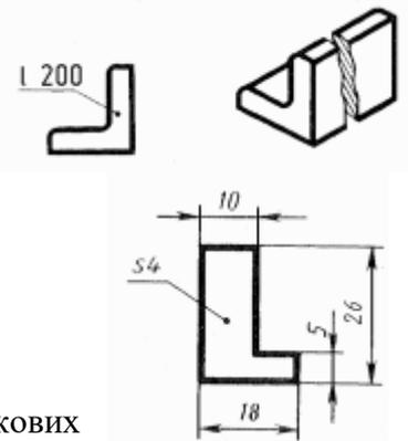
Якщо декілька інженерів виконають креслення однакових деталей, то розміри кожен нанесе по різному. Тому розміри наносять на вільному місці.
