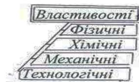
**А) Фізичні властивості** металів проявляються при дії фізичних явищ, які діючи на метал, не змінюють його складу. Наприклад, при нагріванні метал розплавляється, але його склад залишається попереднім.
