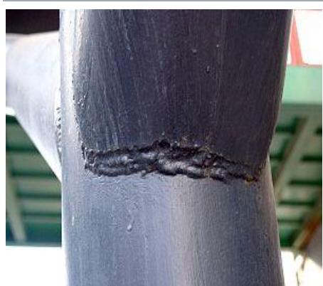
Дефекти зварних з'єднань — будь-які відхилення від заданих нормативними документами параметрів з'єднань при зварюванні, що утворилися внаслідок порушення вимог до зварювальних матеріалів, підготовки, складання і зварювання деталей, термічної та механічної обробки зварних з'єднань й конструкції в цілому. *неякісно виконане зварне з'єднання (не повний пропар, нерівна поверхня та нерівномірна ширина шва, бризки металу)*
