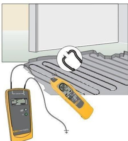
Набагато складніше визначити точку пошкодження в прихованій проводці. Сучасною промисловістю вже давно випускаються прилади класу Е-121, що дозволяють вирішити цю проблему. Він дозволяє визначати не тільки положення ліній електричної мережі, але і виявити місце, де стався порив. Цей прилад дуже простий в експлуатації. Його потрібно просто вести уздовж кабелю, прокладеного всередині стіни, і стежити за роботою спеціального сигналізатора. Місце розриву визначається за особливими магнітними
