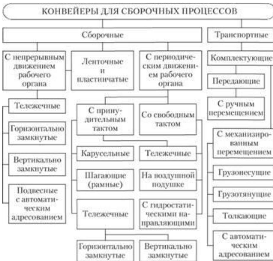
*Рис. 17.9. Типы конвеєрів, застосовуваних при складальних роботах*
