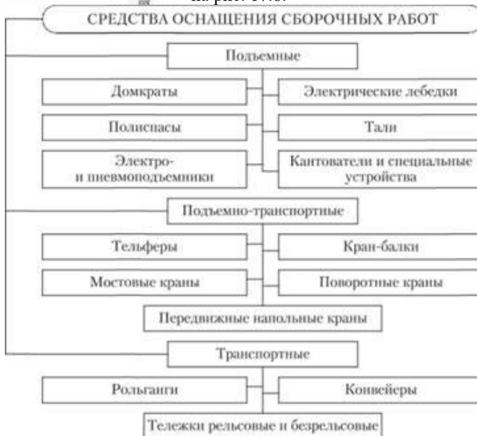
Рис. 17.8. Підйомно-транспортні засоби для складальних виробництв
