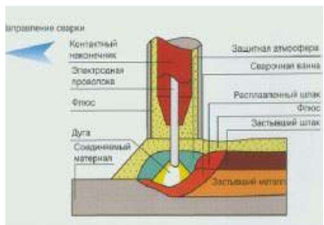
На зварювальному апараті треба встановити робоче значення струму, при якому буде проводитися зварювання. Її визначають виходячи з марки електрода, типу стали, виду зварного шва, місці його розташування на металевій конструкції і в просторі. Щоб утворилася дуга, необхідно електрод піднести до початкового місця для зварювання. При цьому електрод і метал повинні бути перпендикулярні. Після того як вони стикнуться, електрод піднімають на 2-5 мм від металу, в результаті чого утворюється дуга.
