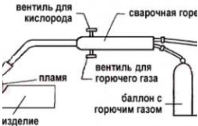
Принцип газового зварювання. При виконанні зварювальних робіт необхідно дотримуватися вимог техніки безпеки, завдяки яким зварювальник захищений від шкідливої дії бризок металу, опіків для очей. Такий захист здатна забезпечити маска зварника, яка продається в спеціалізованих магазинах. Спеціальне скло, яке розміщується в масці,
