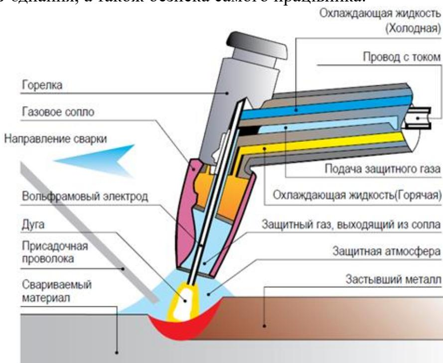
Процес зварювання електродом.
