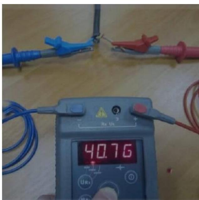
**Вимірювання опору ізоляції** - обов'язкова процедура, яка регулярно застосовується при експлуатації електротехнічних систем і устаткування, у відповідність до вимог ПУЕ. Дані електровимірювальні заходи спрямовані на те, щоб визначити опір ізоляції кабелю і стан кабельно-проводникової продукції, тим самим забезпечити безпечною експлуатацію електричних мереж.
