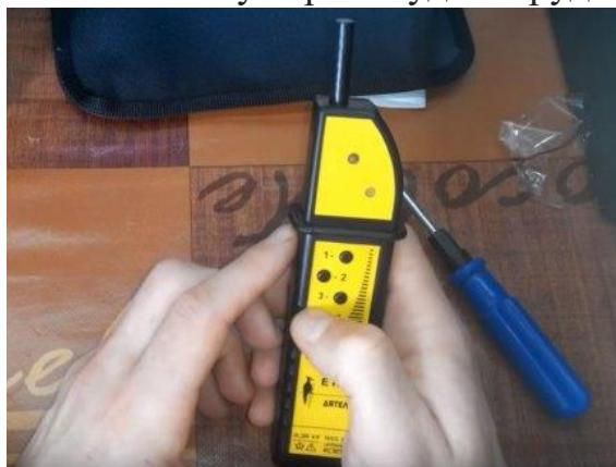
Вітчизняний детектор «Дятел Е-121» ефективно виявляє проводку на глибині до 8 см і коштує в межах 15 \$, що гарантувало йому популярність серед електромонтерів. Для тестування запобіжників і плавких вставок необхідно включити режим «1» або «2» і доторкнутися антеною до контактів до і після запобіжника. При несправності детектор не подаватиме сигнал.
