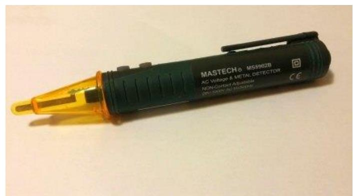
звуковим індикатором виявлення електропроводки.
