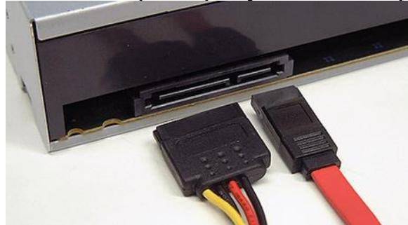
Для сучасних комп'ютерів підключення за допомогою SATA не створює ніяких проблем. Все що вам потрібно зробити, це вставити вузький SATA кабель в дисковод і материнську плату, а також підключити живлення від блоку живлення за допомогою широкого SATA кабелю. Після цього підключення дисковода до комп'ютера можна вважати завершеним.
