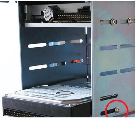
Після того як ви відключили кабелі і відкрутили гвинти можна приступати до зняття старого дисковода. Дисковод треба трохи підштовхнути назовні системного блоку, після чого акуратно витягнути його, взявшись рукою за його передню частину.
