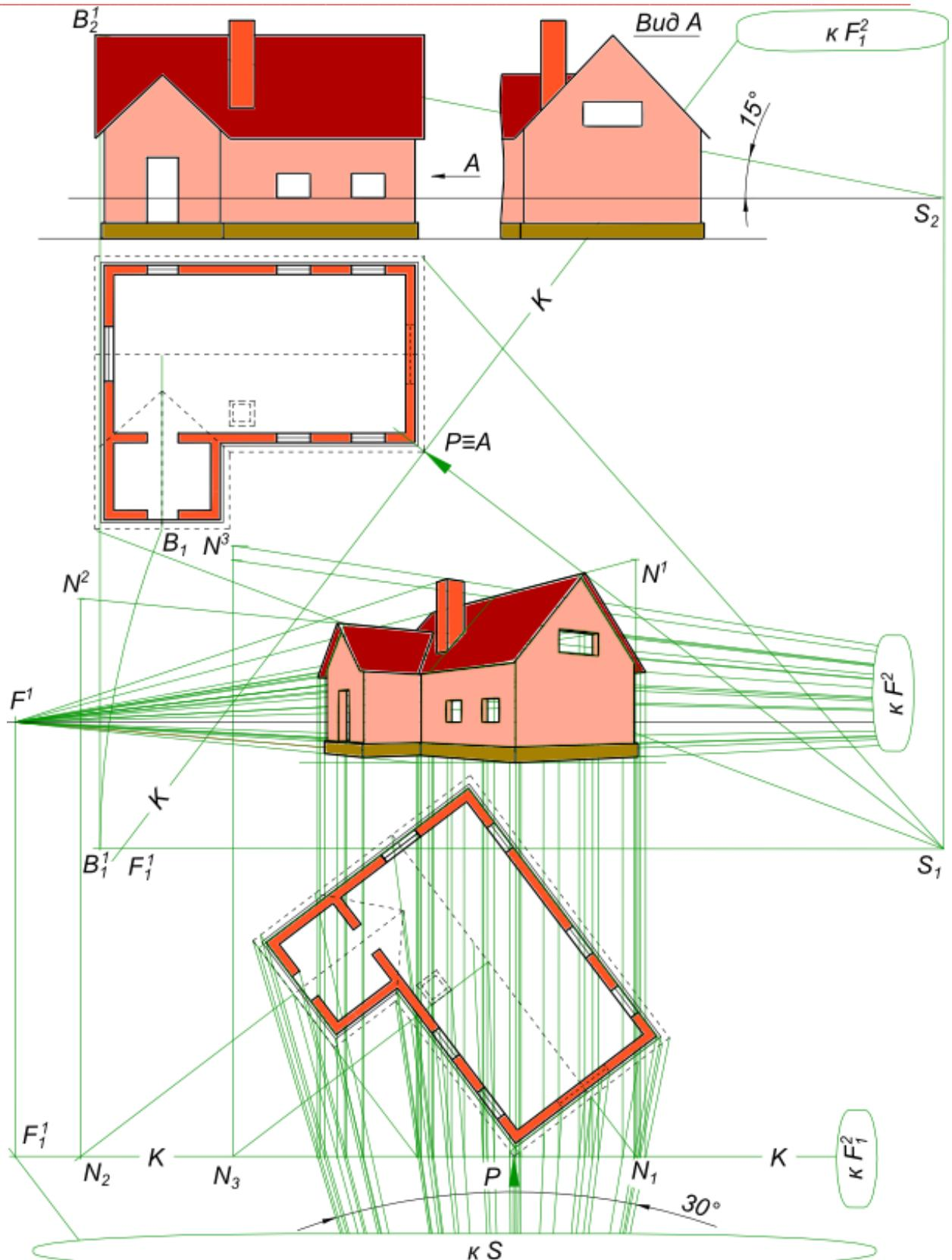
Точка зору вибрана так щоб була забезпечена видимість основних елементів будівлі. Лінію горизонту проводимо на рівні низу віконних отворів. Перевірку по вертикалі виконуємо спрощено, перевіркою кута нахилу крайнього верхнього променя SB до горизонтальної площини. Для цього промінь SB обертаємо навколо вертикальної осі до положення паралельного фронтальній площині проекції SB1.
