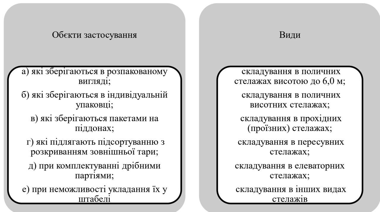
Рис. 3. Характеристика стелажного способу укладання
