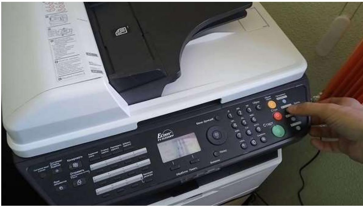
Всі копіювальні апарати живляться від мережі, енергоспоживання в режимі очікування рідко перевищує 50 Вт / ч, в процесі друку споживана потужність зростає до 1 – 1,5 кВт / год.
