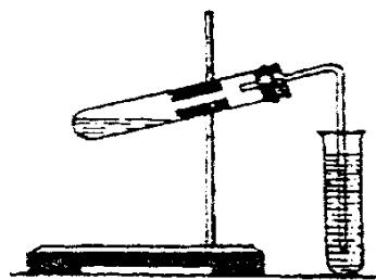
Мал. 1. Прилад для добування вуглекислого газу
