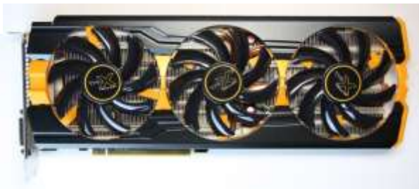
Система охолодження на відеокарті Sapphire Radeon R9 290X
