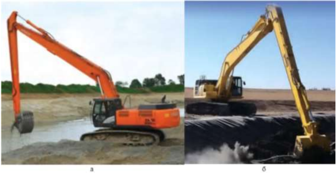
Рис. 3. Екскаратори зі збільшенням РО при виконанні робіт: а – Hitachi ZX 250LC при роботі на розчищенні каналу; б – Komatsu PC 240LC-10.
