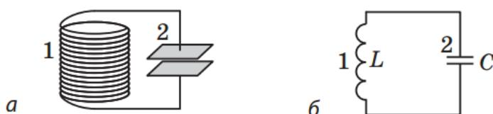
**Рис.1. Модель (а) та електрична схема (б) коливального контуру: 1 – катушка індуктивності; 2 – конденсатор**
