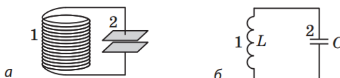
Рис.1. Модель (а) та електрична схема (б) коливального контуру: 1 — котушка індуктивності; 2 — конденсатор
