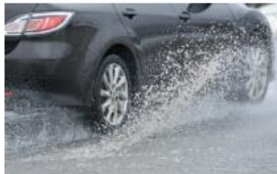
Рис. 2. Швидкості руху іскор феєрверка, бризок зпід коліс автомобіля, металевих ошурок напрямлені по дотичній до кола. Саме в цьому напрямку частинки продовжують свій рух після відриву
