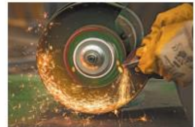
Рис. 2. Швидкості руху іскор феєрверка, бризок зпід коліс автомобіля, металевих ошурок напрямлені по дотичній до кола. Саме в цьому напрямку частинки продовжують свій рух після відриву
