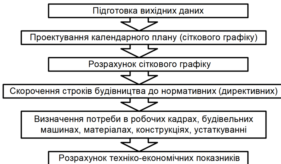
Рис. 11.1. Укрупнена блок-схема проектування календарного плану (сіткового графіку) будівництва об'єкта
