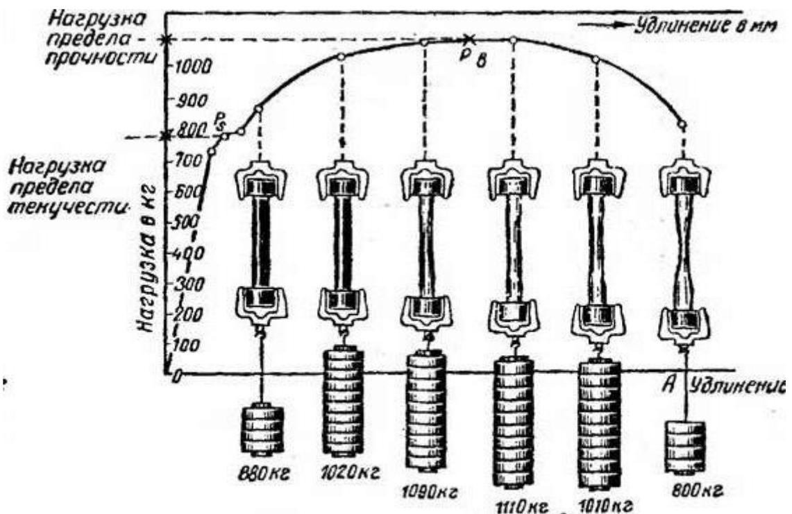
Рис. 21. Диаграмма деформации при испытании металлов на растяжение [ferrum.at.ua](http://ferrum.at.ua)
