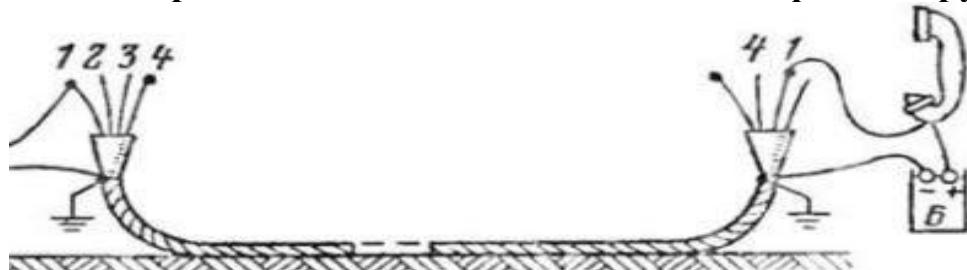
Продзвонити можна наступним чином: кабель з одного боку з'єднується з провідником трубки, а інший провідник - до будь-якої жили. З іншого боку кабель з'єднує з провідником трубки, а інший - до кожної оселя по черзі. Якщо в трубці працівники чують один одного, значить, вони приєдналися до одного і того ж провідника.
