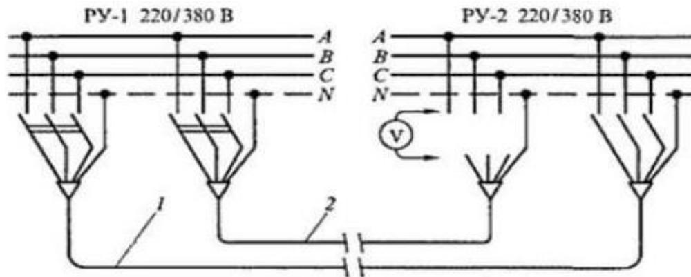
Фазування можна зробити декількома способами: використовуючи вольтметр або лампу розжарювання. Вольтметр використовується для установок 380/220 В. Методика полягає в наступному: кабель 2 в першій установці приєднується завдяки рубильника, а в другій завдяки вольтметру визначає напругу між житловою і шиною, до якої планується її підключити.
