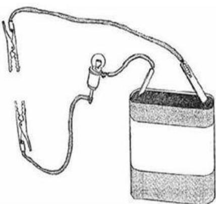
Для того щоб прозвонка працювала правильно, необхідно кабель маркувати в будь-якому порядку. Методика роботи такого пристосування полягає в наступному: до одній жилі приєднують провід, що йде від батареї, а до щупа прикріплюють лампочку. Цим щупом по черзі торкатися до провідників на протилежному кінці кабелю. Якщо лампочка засвітилася, значить, цей провід з'єднаний з батарейкою.
