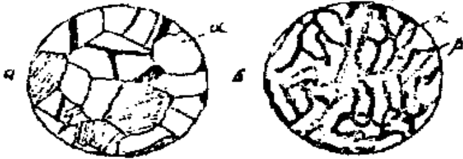
Мал. 3.1 Мікроструктури латуней.
