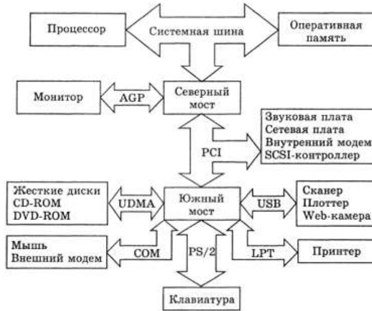
Рис. 3. Схематичне зображення всіх компонентів та роз'ємів на материнській платі
