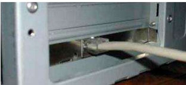
Рисунок 2 – Підключення обтиснутої витної пари до мережевої карти
