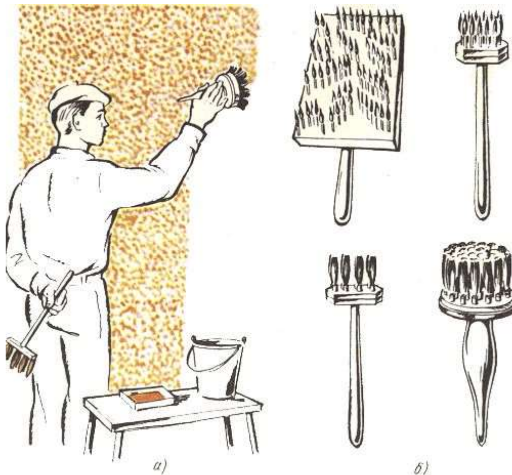
Рис.6. Техніка обробки (а) складальними торцюваннями (б)
