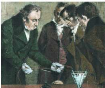
Рис. 10.1. Дослід Ерстеда: поблизу провідника зі струмом магнітна стрілка відхиляється від напрямку «північ — південь», намагаючись розташуватися перпендикулярно до провідника
