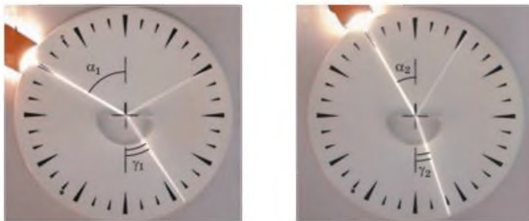
Рис. 3. Установлення законів заломлення світла: в разі зменшення кута падіння \alpha_2 < \alpha_1 кут заломлення теж зменшується, при цьому \gamma_2 < \gamma_1 . при цьому \frac{\sin \alpha_1}{\sin \gamma_1} < \frac{\sin \alpha_2}{\sin \gamma_2} .
