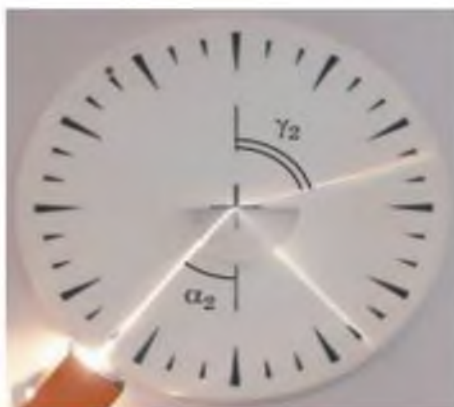
Рис. 5. Якщо світло падає зі скла в повітря, в разі збільшення кута падіння кут заломлення наближається до 90^\circ , а яскравість заломленого пучка зменшується
