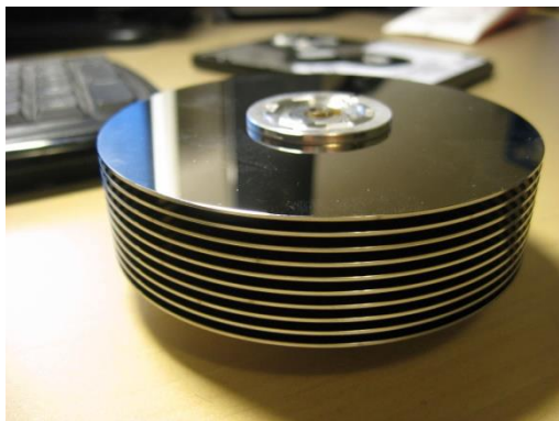
Сток магнітних пластин твердого диска Seagate-ST19171N, об'єм: (9.1 Гбайт)
