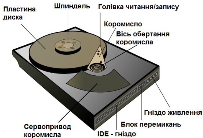
Основні елементи конструкції твердого диска
