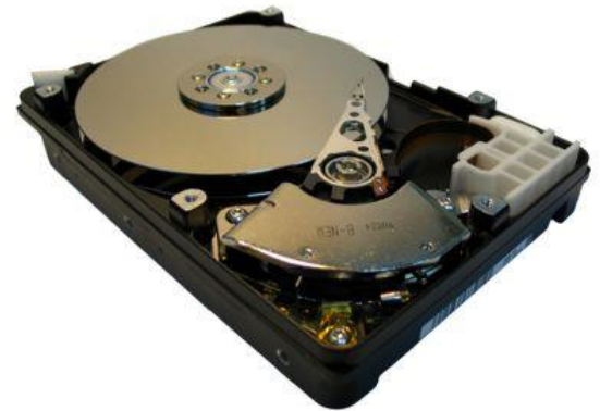
Жорсткий (твердий) магнітний диск зі знятою кришкою
