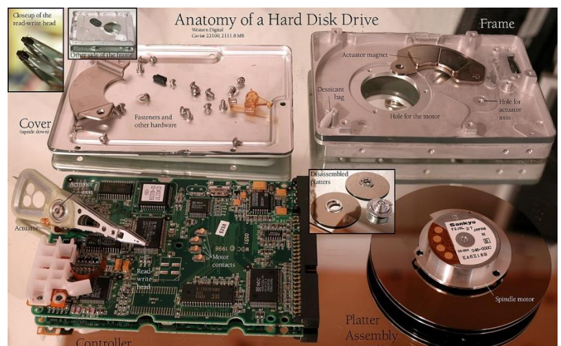
Твердий (жорсткий) магнітний диск у розібраному до основних частин стані
