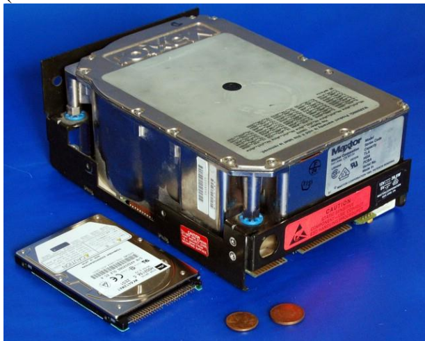
Повнорозмірний (Full-height) 5,25" (110 МБ) твердий диск Maxtor (справа) і малогабаритний 2,5" (6495 МБ) для ноутбуків (зліва)
